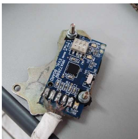
Figura 34: Montagem do acelerômetro
