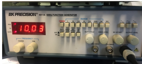
Figura 25: Gerador de sinais B&K Precision 4011A.
