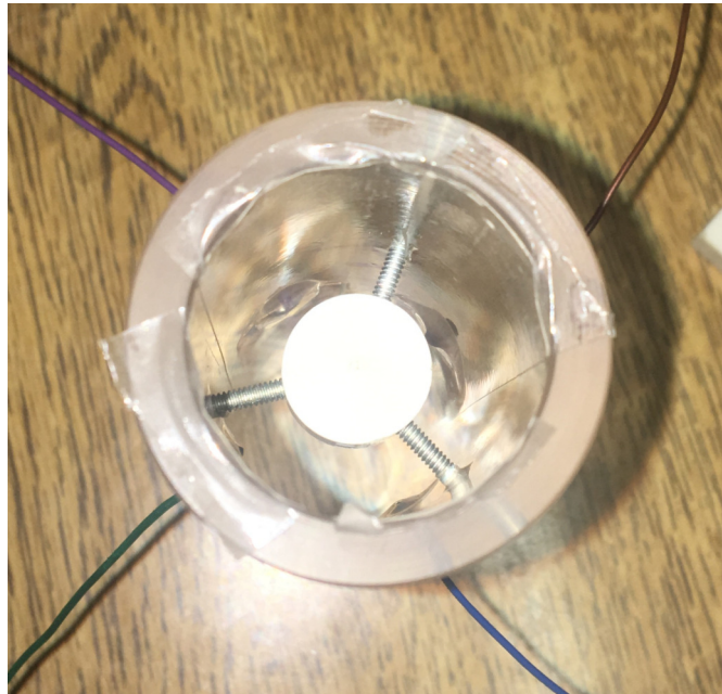
Figura 15: Detalhe da fixação do PVC no centro do tubo.
