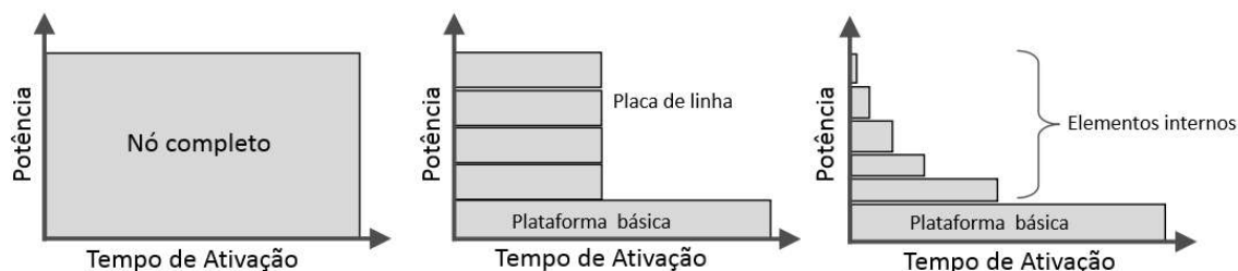
Figura 10 Estados de energia de equipamentos de rede [7].
