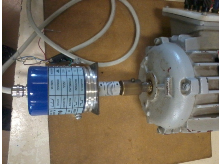
Figura 32 - Encoder utilizado acoplado ao motor de indução
