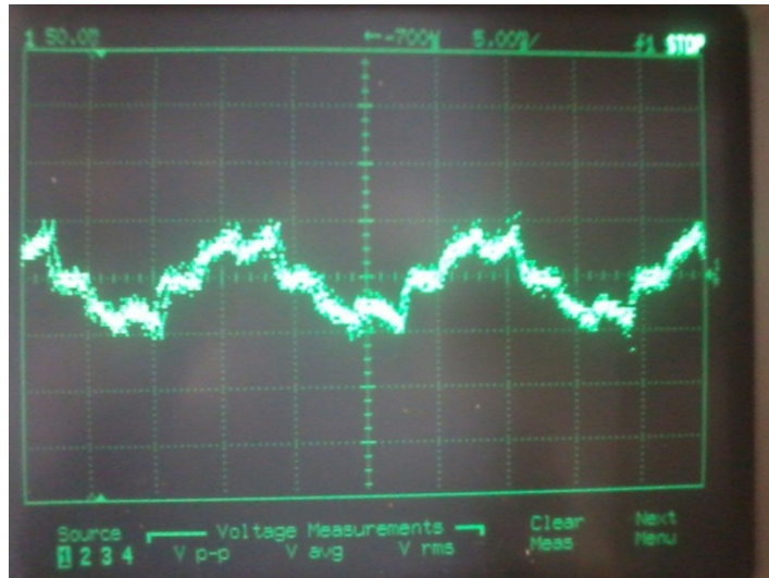
Figura 48 - Modo 2 a 2 – 60Hz – Corrente no motor
