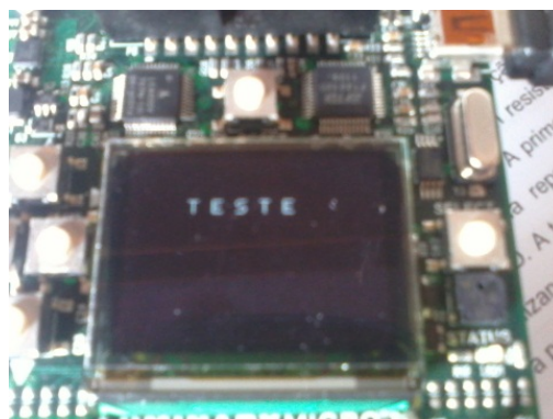
Figura 27 - Teste no display OLED
