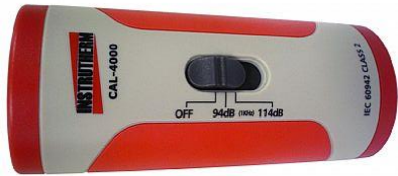
Figura 5. Calibrador para Dosímetro e Decibelímetros mod. CAL-4000 / Nível 94 e 114dB.
