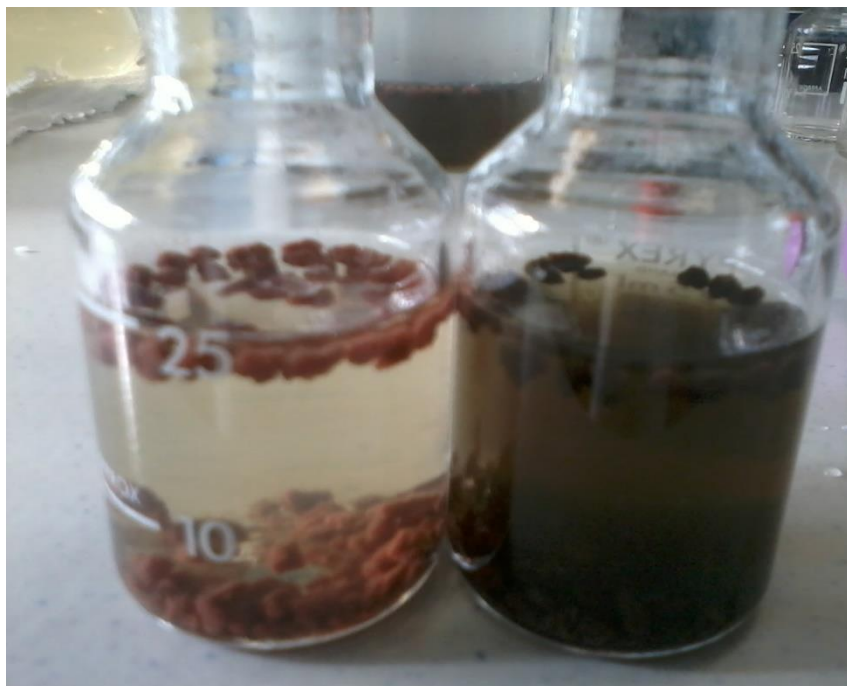
Figura 36 - Comparação da biomassa no frasco controle (esq.) e com 100% de lixiviado (dir.)
