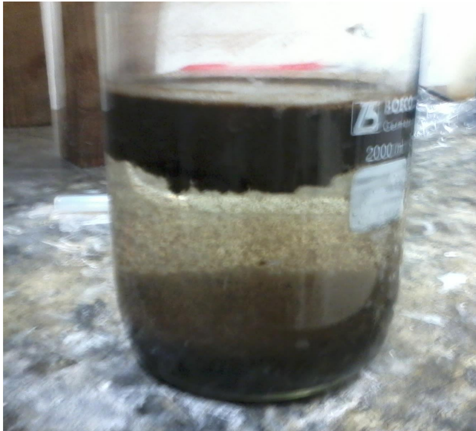
Figura 11 - Flotação da biomassa presente no frasco, evidência da atividade anammox
