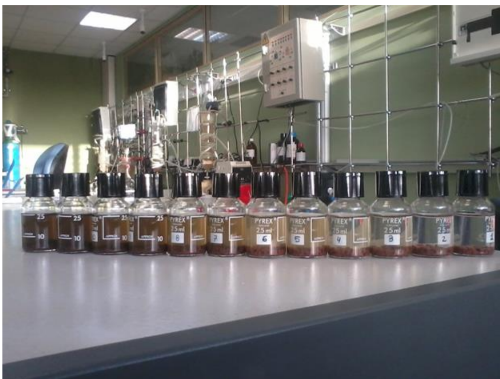
Figura 6 - Composição final do ensaio de inibição por lixiviado com concentração crescente da direita para a esquerda
