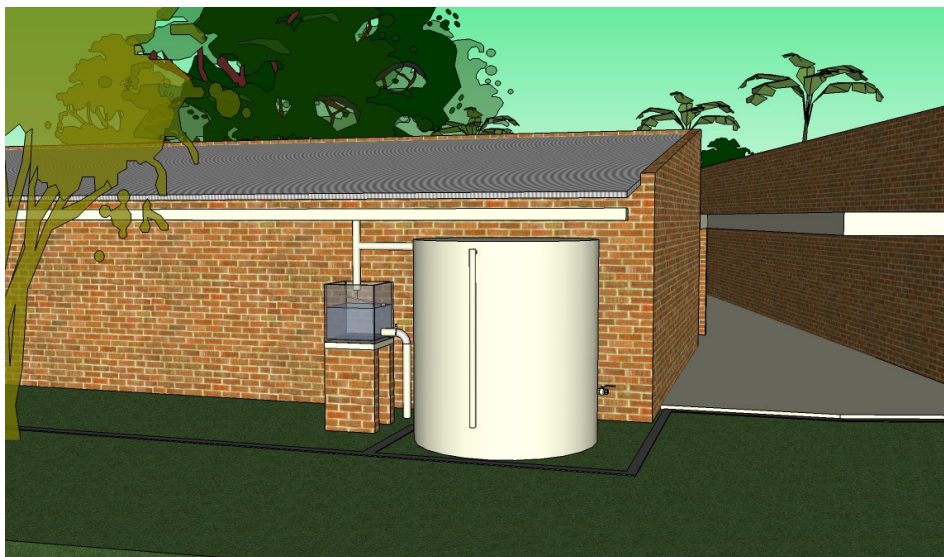
Figura 5.10 – Detalhe da captação do Bloco B.
