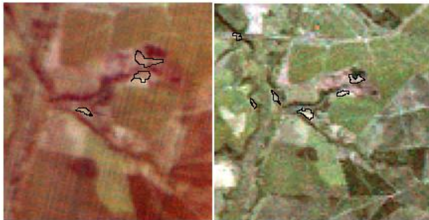
Figura 14: Comparação entre imagens CBERS (esquerda) e LANDSAT (direita) para o ano de 2008 com as feições erosivas detectadas
