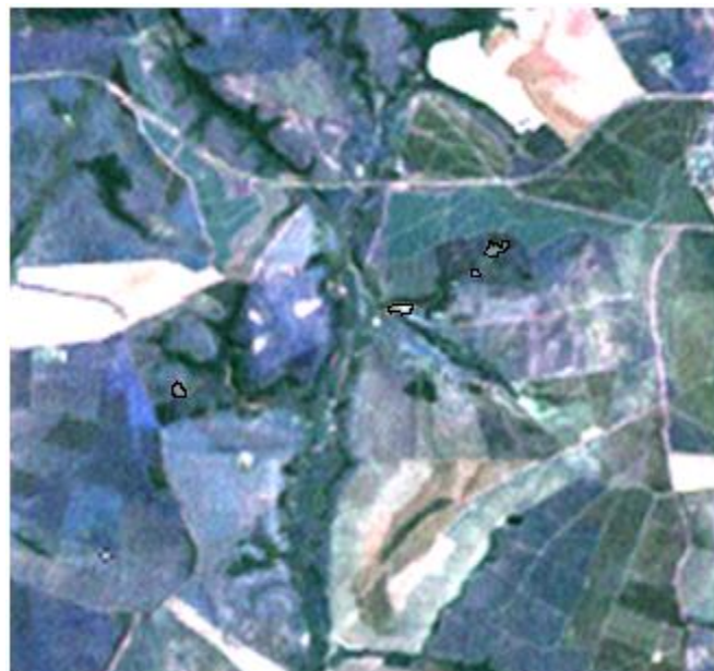
Figura 5: Imagem LANDSAT 7, de 2001, montada com as bandas RGB 3 – 1 – 2 com as feições erosivas detectadas
