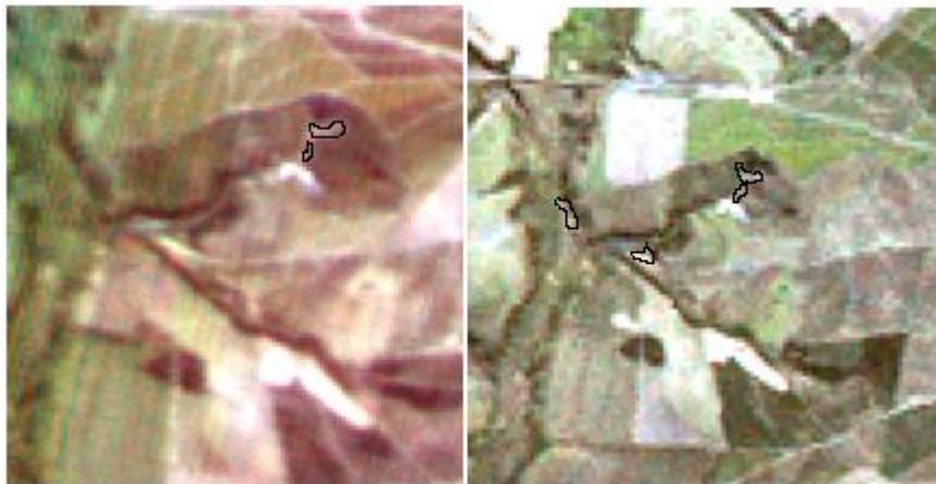
Figura 11: Comparação entre imagens CBERS (esquerda) e LANDSAT (direita) para o ano de 2005 com as feições erosivas detectadas
