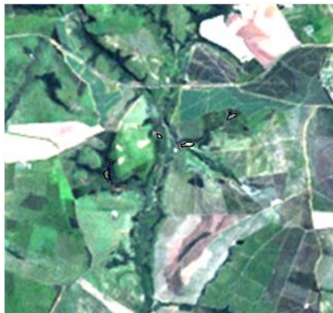
Figura 3: Imagem LANDSAT 7, de 2001, montada com as bandas RGB 3 – 2 – 1 com as feições erosivas detectadas
