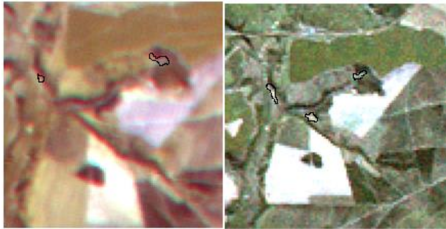
Figura 13: Comparação entre imagens CBERS (esquerda) e LANDSAT (direita) para o ano de 2007 com as feições erosivas detectadas
