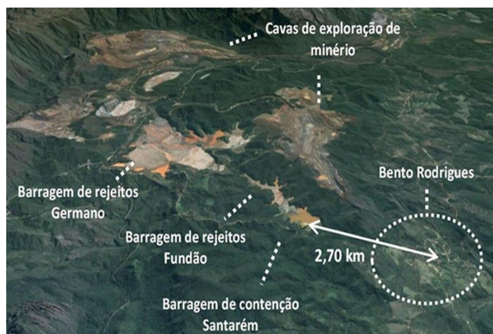
Figura 5 – Distribuição das barragens de contenção de rejeitos em Mariana, antes do desastre.
