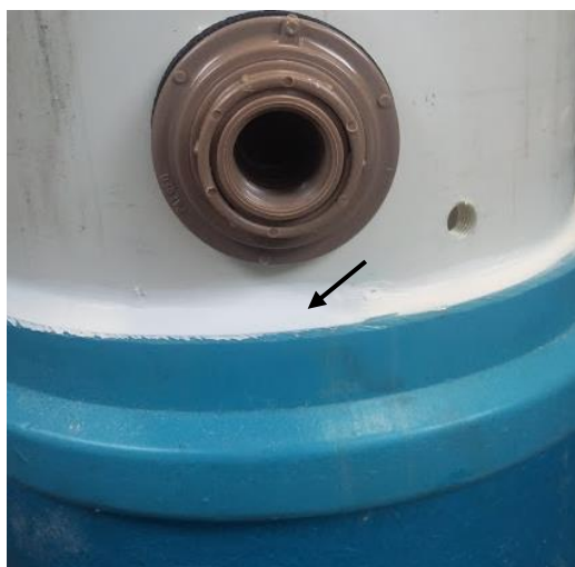
Figura 26. Detalhe da veda calha aplicada no filtro.
