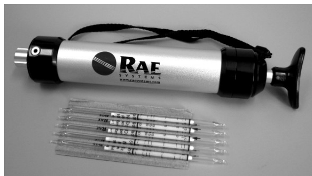
Figura 7. Bomba de sucção manual da marca RAE Systems, modelo LP 1200 e tubos colorimétricos da marca RAE Systems.
