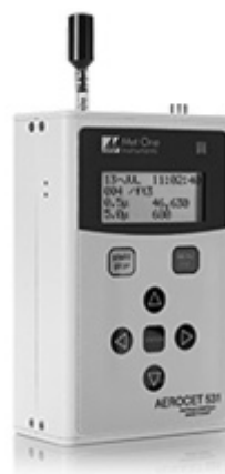
Figura 17. Contador de material particulado AEROCET 531, da marca Met One.
