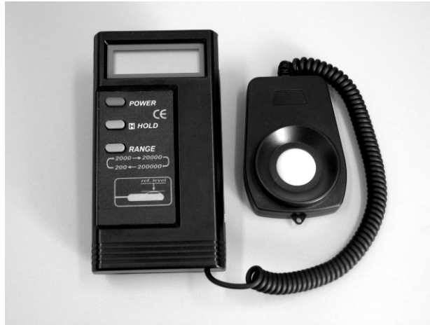
Figura 9. Luxímetro digital da dpUnion, modelo DPU-600.
