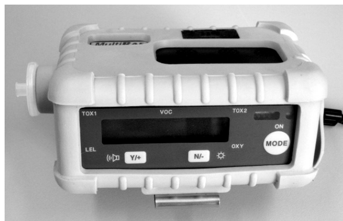
Figura 6. Monitor de gases portátil da RAE Systems, modelo MultiRAE IR - PGM54.
