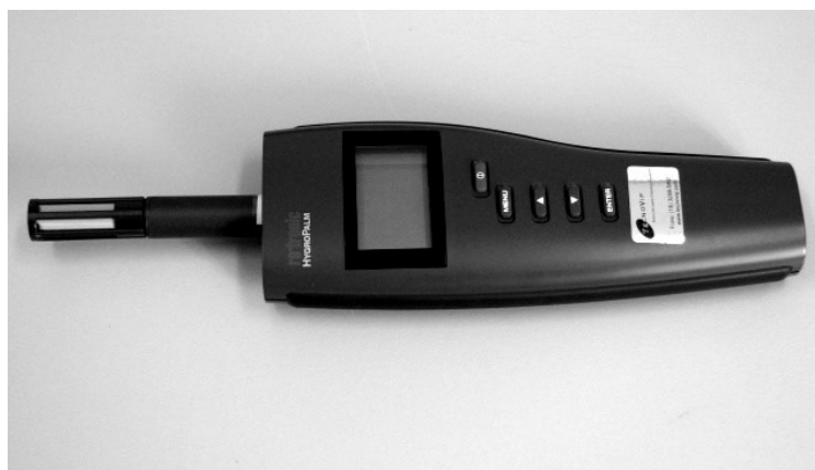
Figura 12. Termohigrômetro digital, marca Rotronic, modelo Hygropalm 0.
