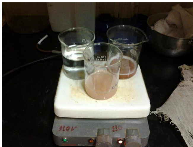
Figura 18: Béqueres com as amostras de solo sofrendo oxidação da matéria orgânica através do aquecimento da mistura com peróxido de hidrogênio.
