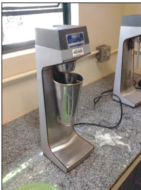
Figura 10: Aparelho usado para dispersão do solo.
