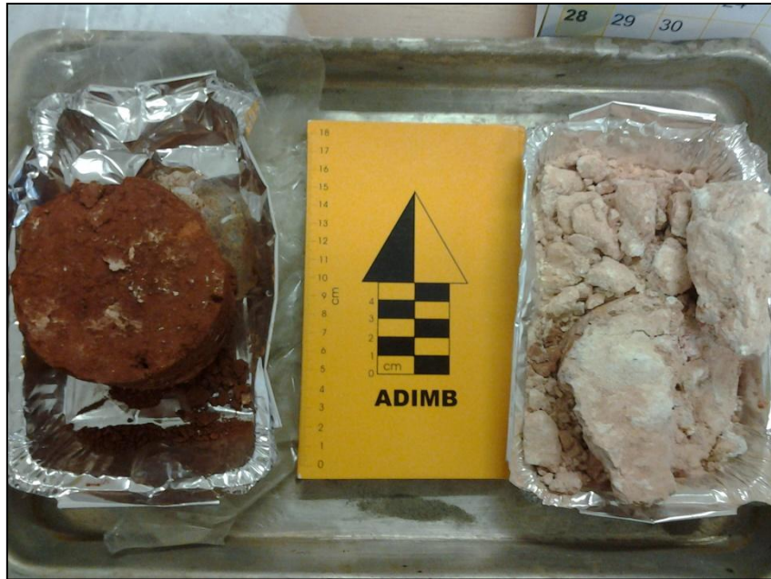
Figura 7: A esquerda da figura tem-se amostra indeformada do LAT1. E a direita da figura tem-se uma amostra deformada do CAM1.
