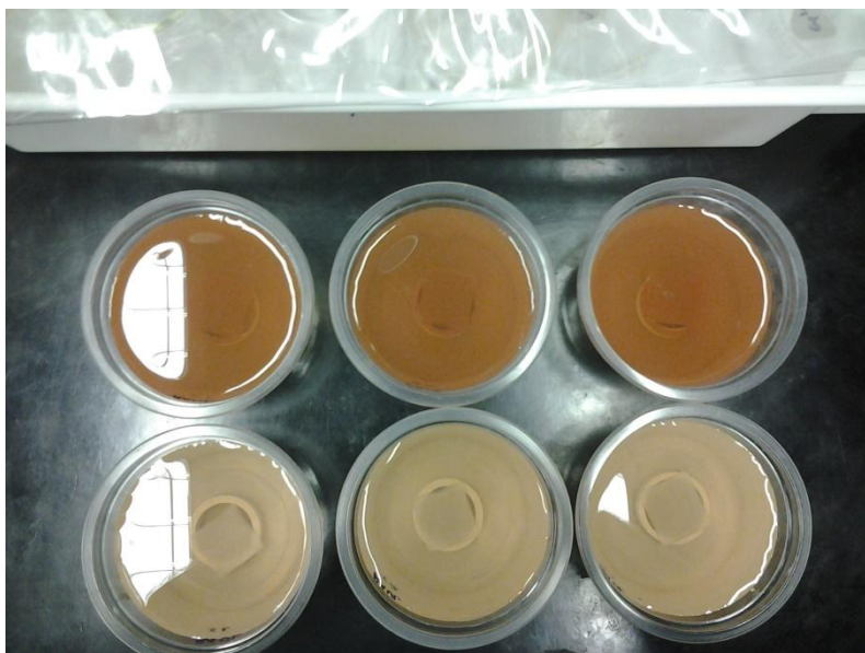
Figura 20: Preparação das amostras para o ensaio de DRX
