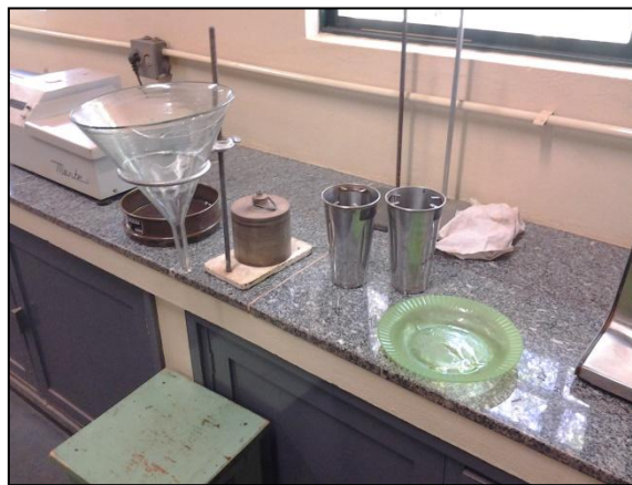
Figura 9: Material utilizado na preparação da amostra para ensaio granulométrico: peneira 10# e copos para dispersão.
