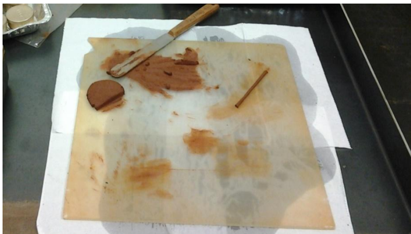
Figura 13: Ensaio de limite de plasticidade em amostra do Latossolo.
