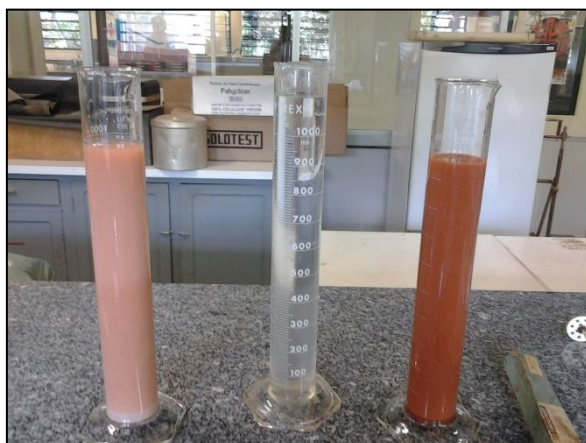
Figura 11: Provetas contendo as amostras e água destilada com um volume total de 1000 cm 3 .
