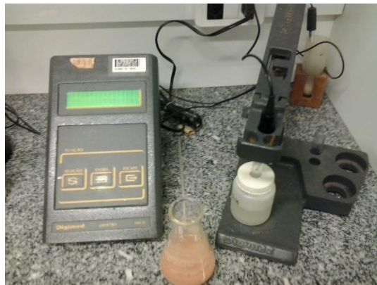
Figura 17: pHmetro Digimed empregado na determinação do pH.
