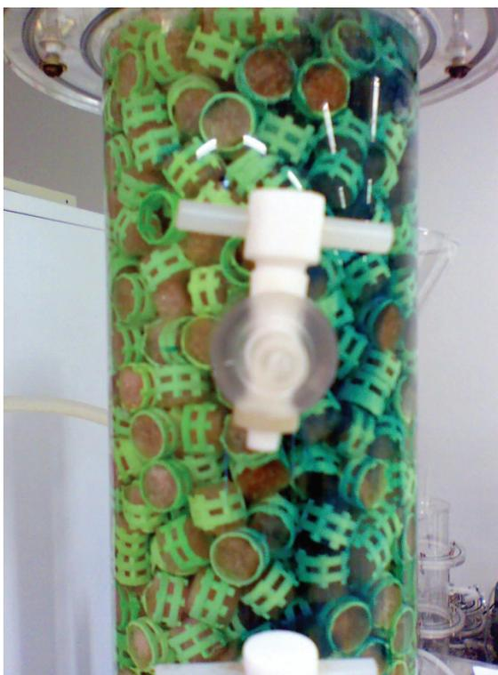
Figura 5.3 – Foto do reator durante ensaio hidrodinâmico com Dextrana Azul, uma hora após a injeção do pulso.
