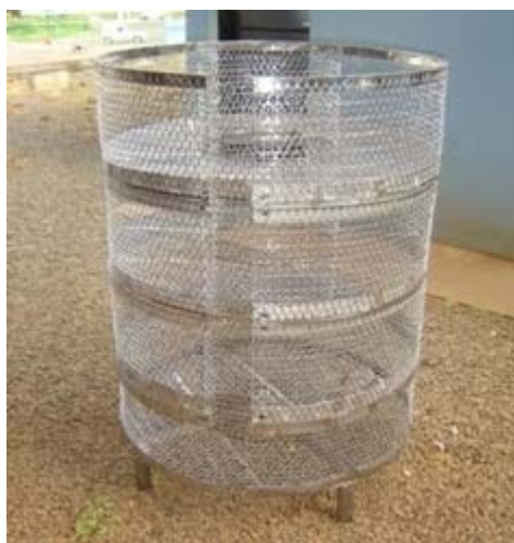
Figura 4.4: Cesto compartimentado com meio suporte espuma de poliuretano para imobilização da biomassa na Configuração 2.
