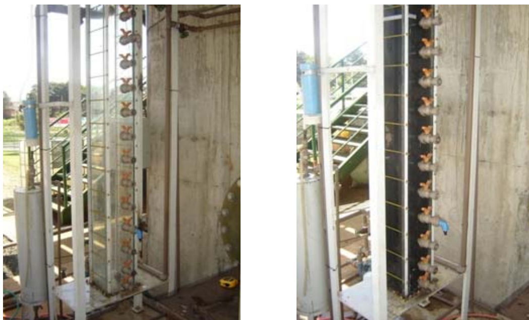
Figura 4.5: Tubo de seção quadrada utilizado para o ensaio de sedimentação.
