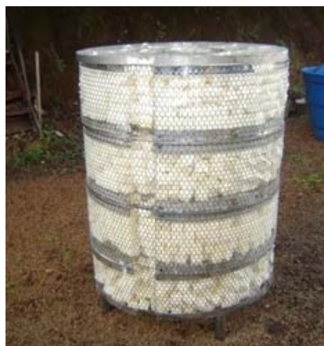
Figura 4.4: Cesto compartimentado com meio suporte espuma de poliuretano para imobilização da biomassa na Configuração 2.
