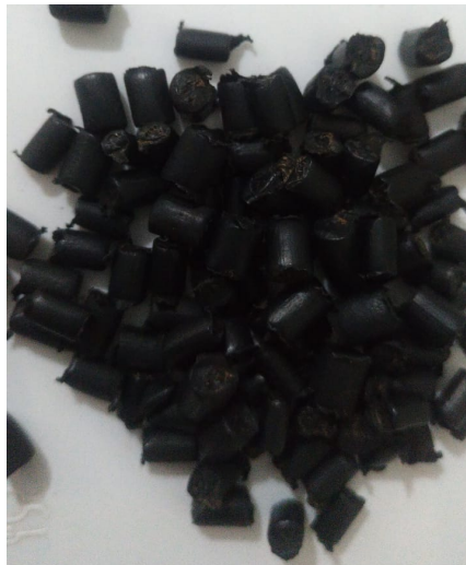
Figura 4 – Polietileno de Baixa Densidade (PEBD) –meio suporte dos RAHLFD
