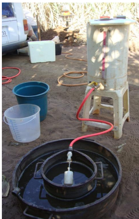
Figura 10 - Ensaio de infiltração com infiltrômetro de duplo anel.
