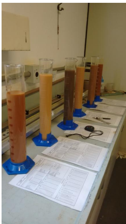
Figura 14 - Etapa de sedimentação da análise granulométrica conjunta.
