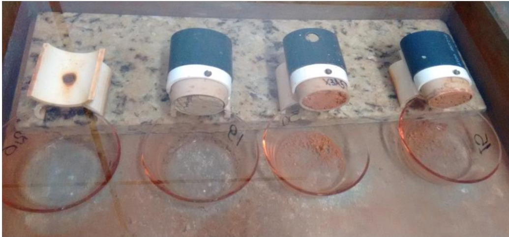
Figura 19 – Equipamento utilizado no ensaio de perda de massa por imersão.
