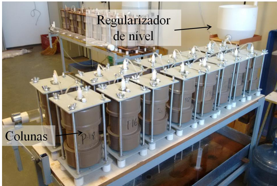
Figura 16 - Ensaio de condutividade hidráulica saturada em laboratório.
