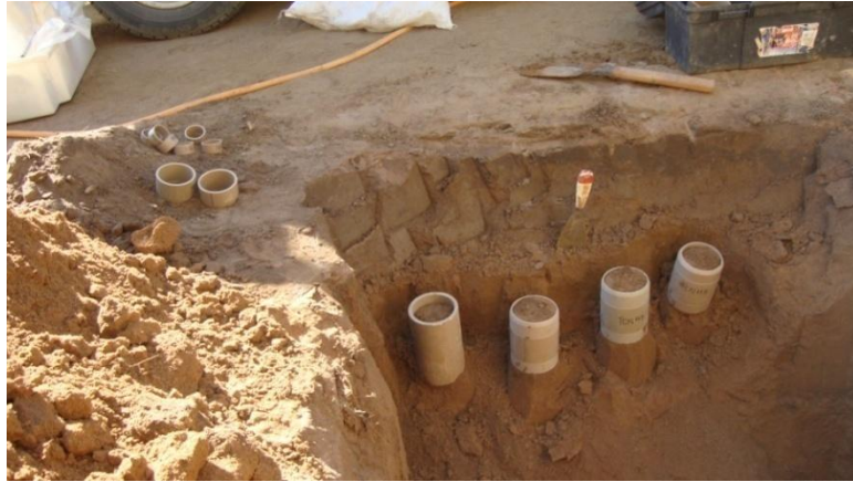
Figura 9 - Extração de amostras em trincheira.
