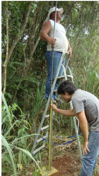
Figura 12 - Ensaio de resistência mecânica à penetração
