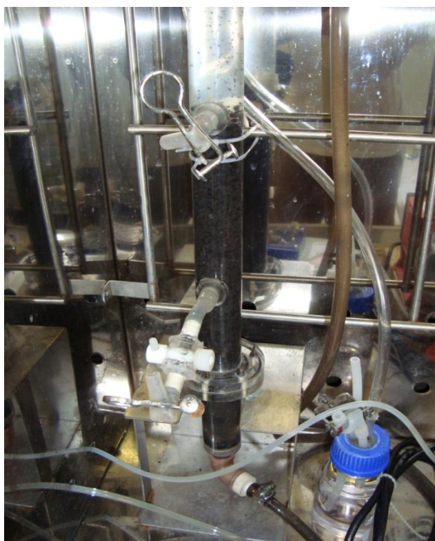
Figura 5.12 - Reator EGSB após a adição de resazurina para constatação de anaerobiose
