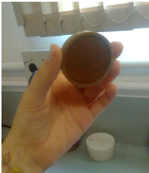
Figura 15- Anel contendo material indeformado utilizado para o método de papel filtro.
