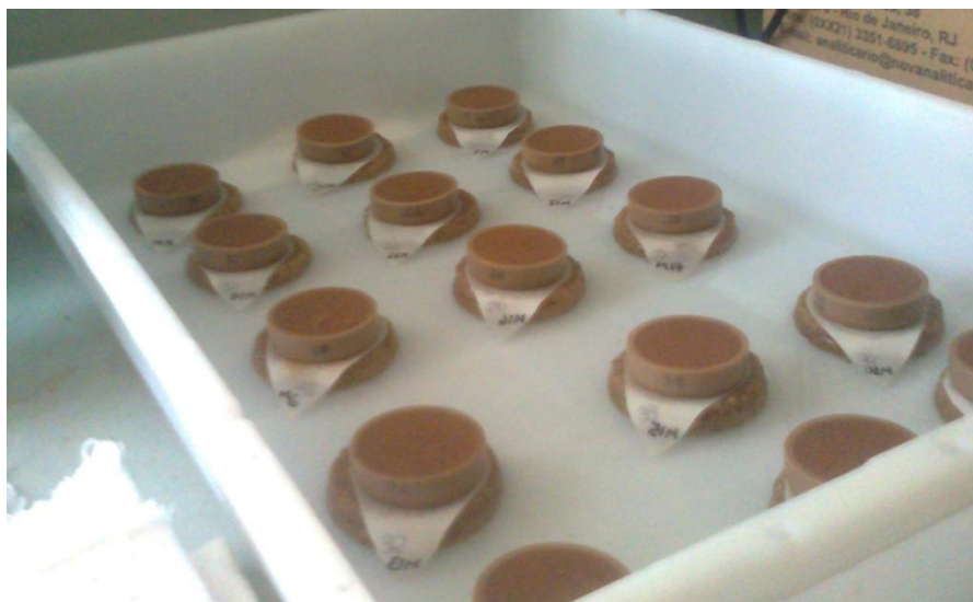
Figura 17 - Processo de saturação dos corpos de prova de maneira indireta.
