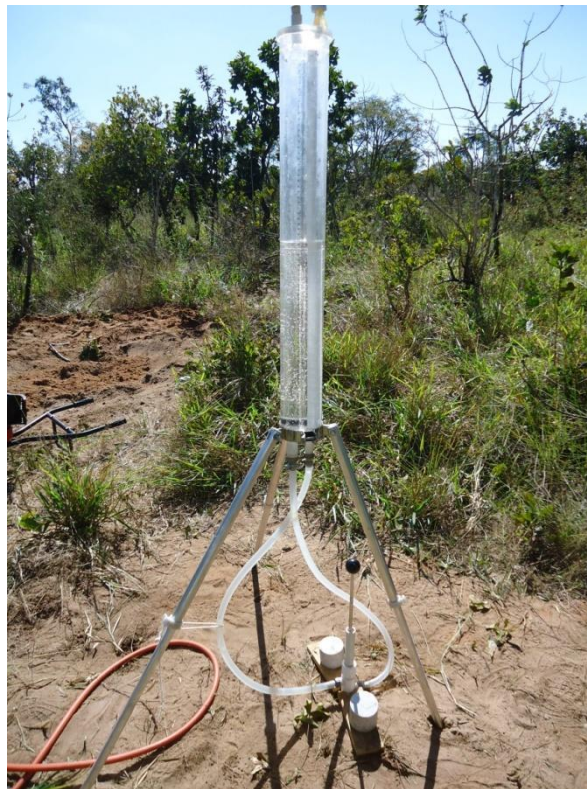
Figura 11 – Permeâmetro de Guelph modificado.
