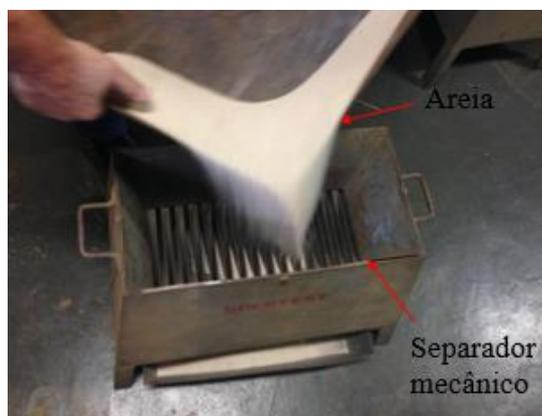
Figura 2. Areia passando pelo separador mecânico para homogeneização (procedimento do ensaio granulométrico)
