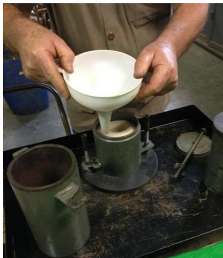
Figura 3. Areia no recipiente para a determinação de compactidade relativa
