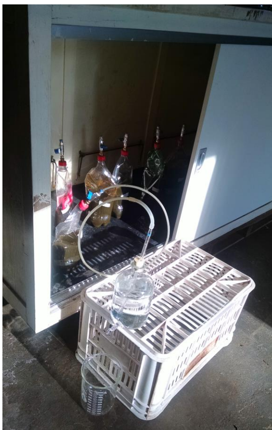
Figura 15: Montagem do experimento com Mariotte.
