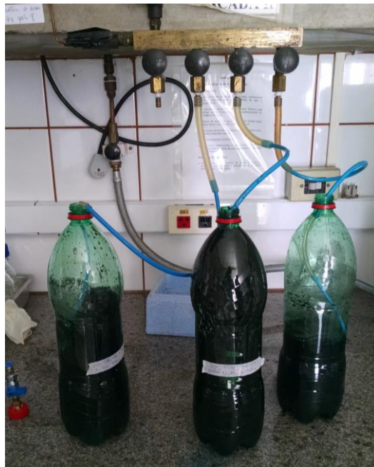
Figura 8: Purga do meio de reação com nitrogênio.
