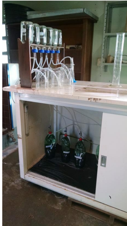
Figura 11: Reatores mantidos dentro da estufa na temperatura em torno de 35\pm 2 °C.
