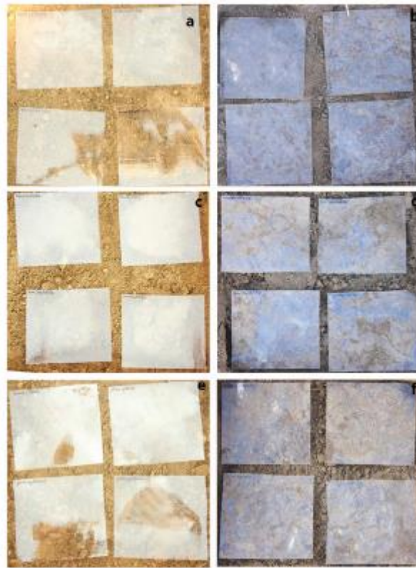
Figura 23 - Evolução visual dos filmes de PET enterrados no solo arenoso em um período de 1095 dias (“a” e “b” correspondem ao PET; “c” e “d” ao PET E5; e “e” e “f” ao PET W5). Fonte: Selke et al. (2015)
