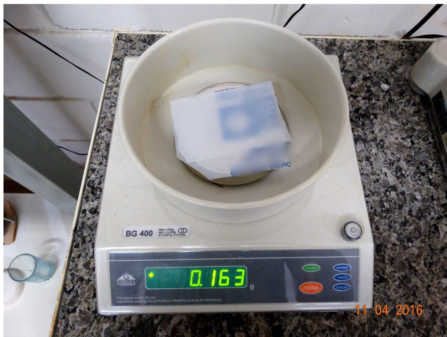
Figura 36: Pesagem de amostra utilizando balança eletrônica de precisão semi analítica.
