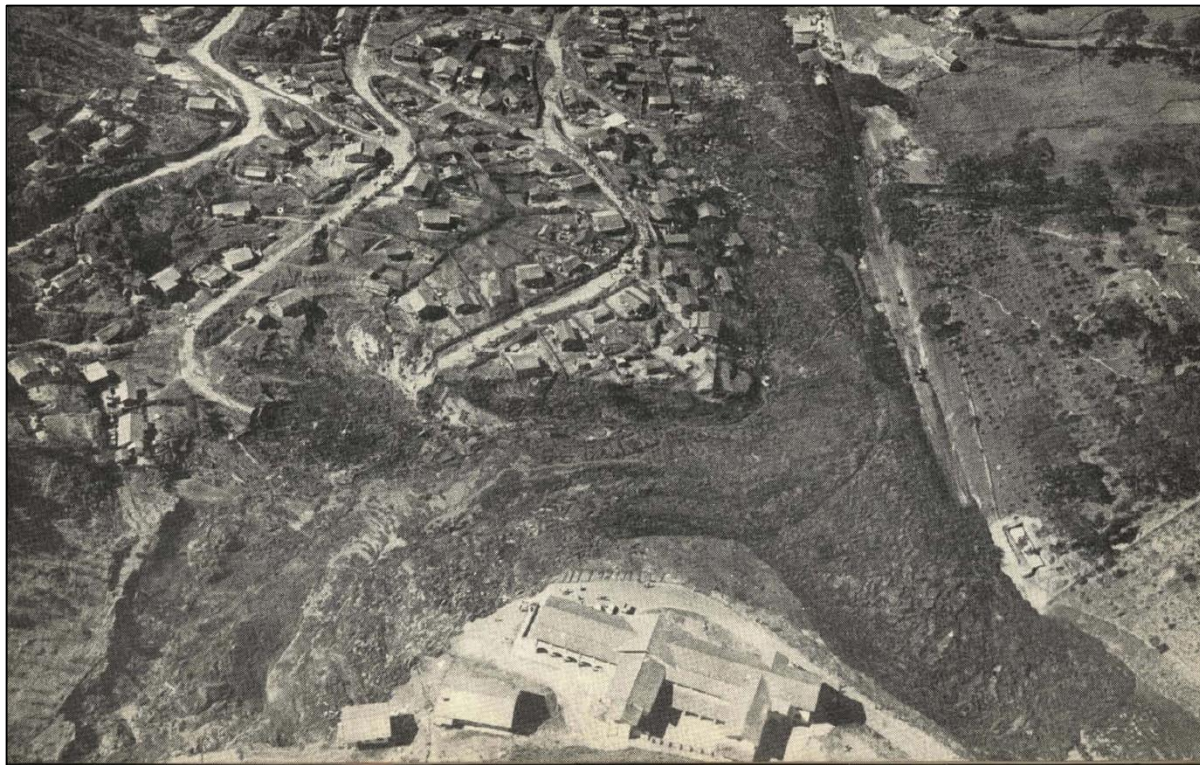
Figura 40 – Vista aérea da área afetada pelo movimento de massa em 1972 no município de Campos do Jordão-SP. Nessa foto pode ser observado o anfiteatro, a área fonte do material turfoso e o vale afetado
