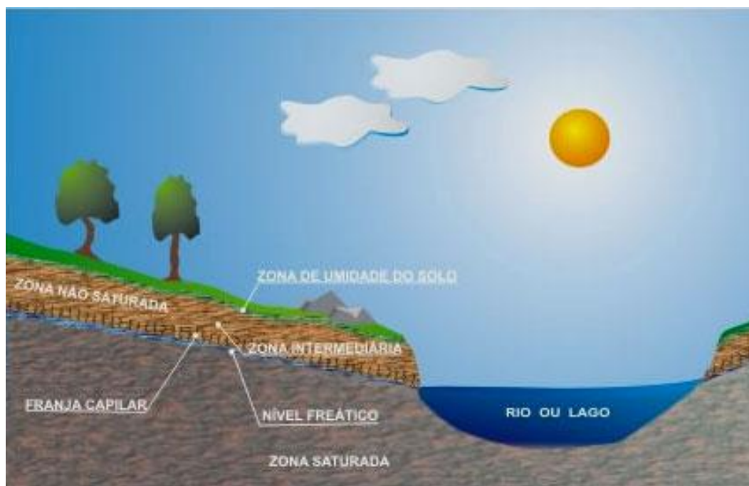
Figura 1: Esquema das zonas não saturada e saturada no subsolo (BORGHETTI et al. , 2004).
