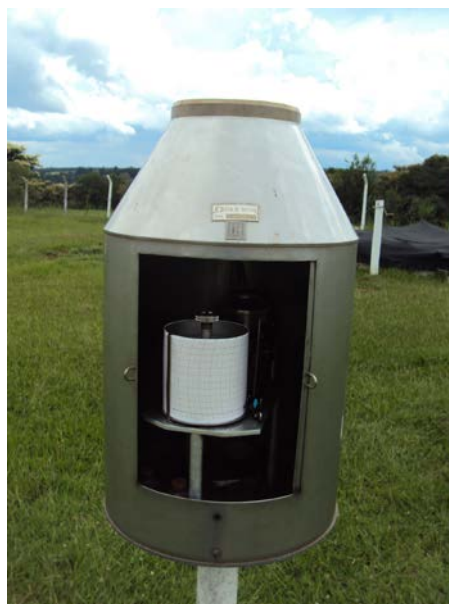
Figura 10. Pluviógrafo. Fonte: CRHEA – EESC/USP (2011)
