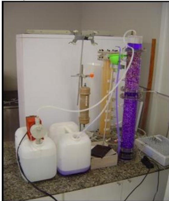
Figura 6 - Fotografia do aparato experimental utilizado capturada durante ensaio com Dextrana Azul.
