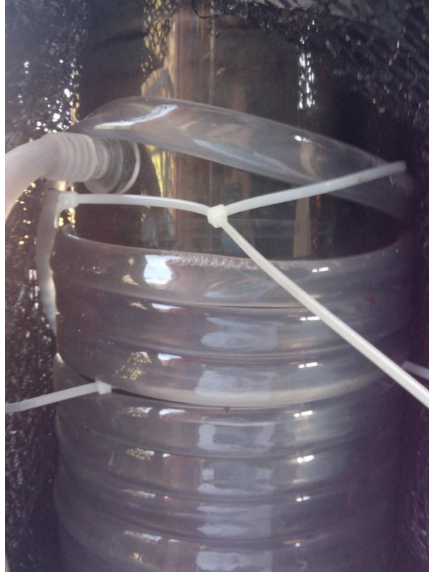
Figura 4.3 - Sistema de manutenção da temperatura no reator
