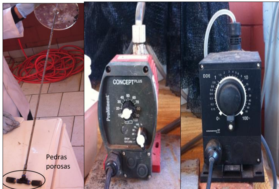
Figure 4 - Bombas e estrutura de distribuição de ar
