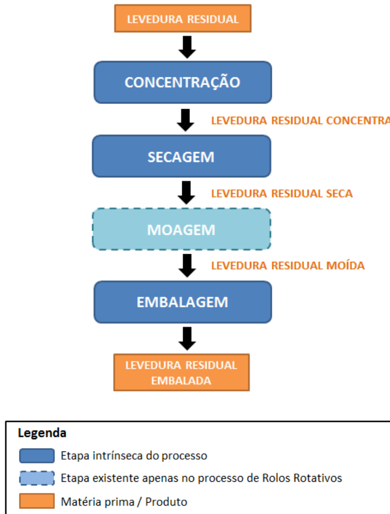
Figura 3.7 – Processo de utilização da levedura residual como ração animal
