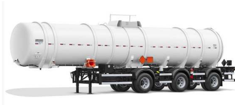
Figura 14 - Semirreboque tanque de combustível cilíndrico
