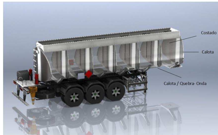
Figura 15 - Tanque de combustível formato elíptico
