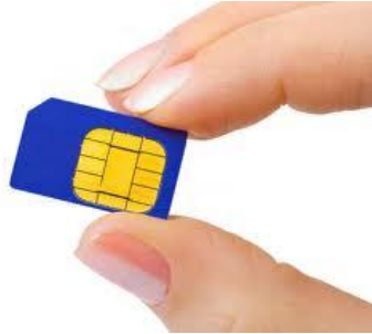
Figura 3 - Exemplo de Poka Yoke em um chip de celular.
