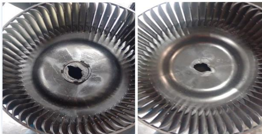
Figura 4.8 Etapa D2: rotor quebrado
