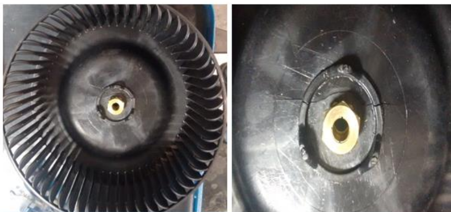
Figura 4.9 Etapa D2: rotor quebrado e desbalanceado
