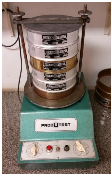
Figura 2. Conjunto de peneiras e agitador utilizado para análise granulométrica do fertilizante.
