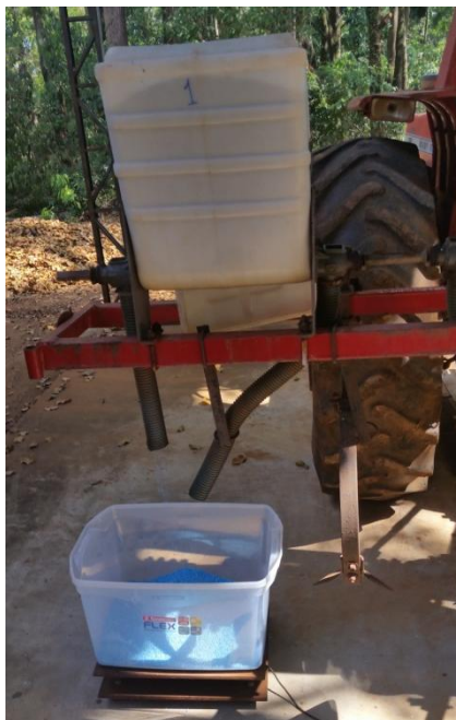
Figura 6. Coleta do fertilizante em célula de carga para determinação da vazão.
