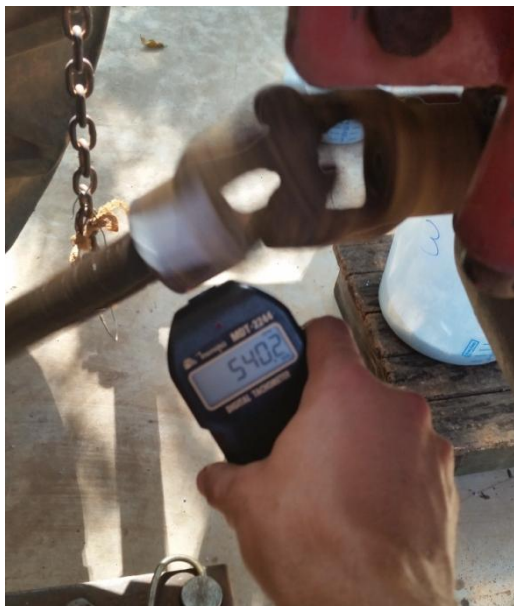
Figura 4. Tacômetro manual utilizado para monitoramento da rotação da TDP.
