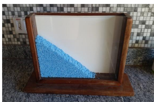
Figura 3. Mecanismo utilizado para determinação do ângulo de repouso do fertilizante.
