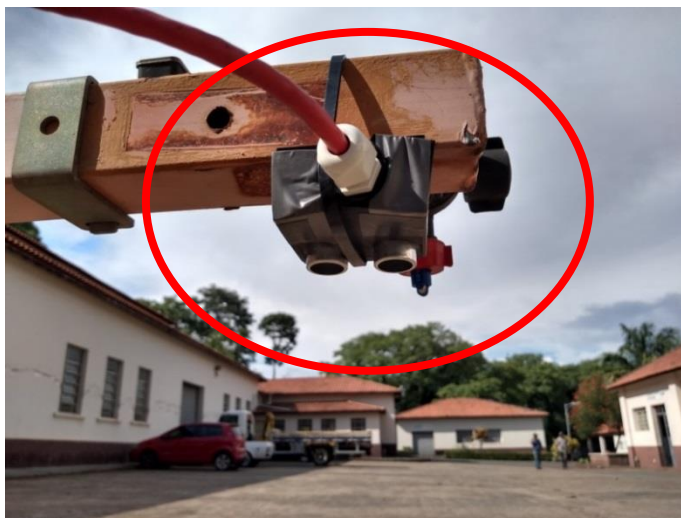
Figura 3. Sensor Ultrassônico fixado na ponta da barra de pulverização.
