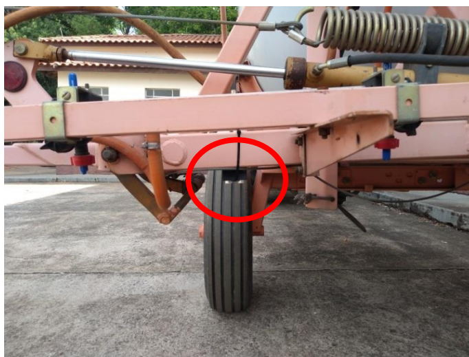
Figura 4. Sensor ultrassônico fixado no chassi do pulverizador.
