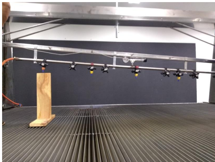
Figura 5. Inclinação da barra de pulverização para avaliação do perfil de distribuição, detalhe do padrão de altura utilizado para fixação da altura em um lado.
