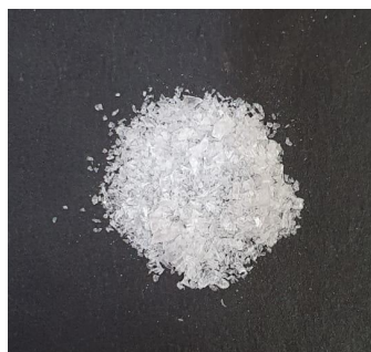
Figura 3: Microplásticos triturados em moinho criogênico para atingir a escala de tamanho de 100 a 350 \mu\text{m} (Acervo pessoal).
